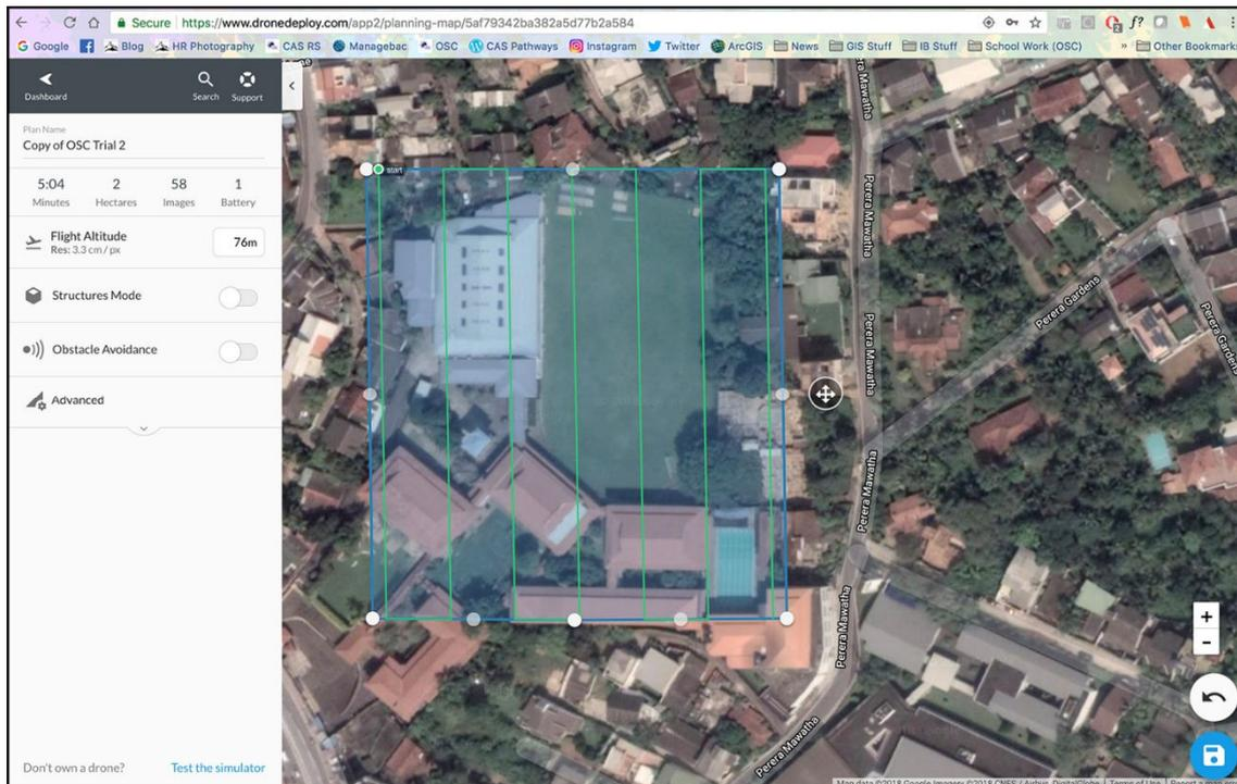
**Figura 17.** Telas do Drone Deploy demonstrando exemplo de plano de voo e ortomosaico.
