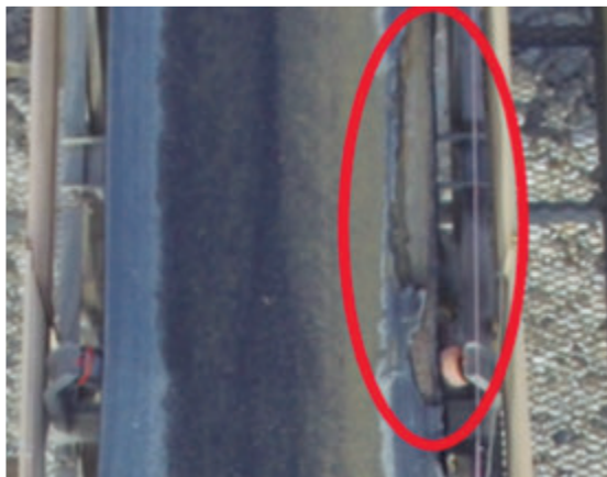
Figura 5 - Desgaste da borda da correia. Fonte: autor.
