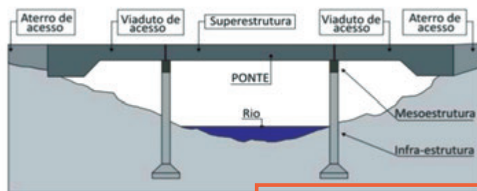
Figura 1 Elementos constituintes da Ponte. Fonte: Marchetti, 2008.
