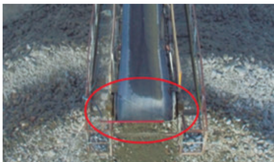
Figura 3 - Local de emenda na correia do transportador. Fonte: autor.
