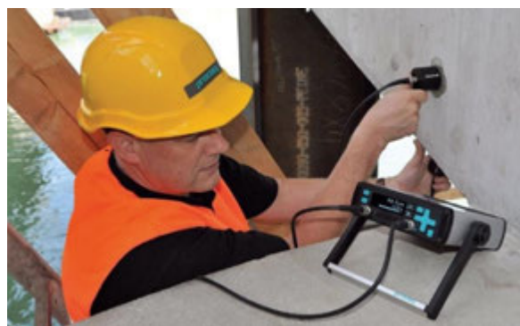
Figura 3 - Ensaio de ultrassonografia de estruturas in loco. Fonte: Site cimento Itambé.
