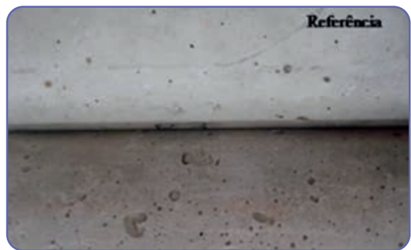
Foto 3: Detalhe mostrando alteração de cor na superfície, comparação entre a amostra não submetida ao tratamento térmico e a amostra submetida ao tratamento térmico a 500°C.
