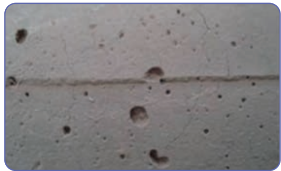
Foto 1: Imagem típica da superfície do concreto da amostra sem tratamento térmico.
