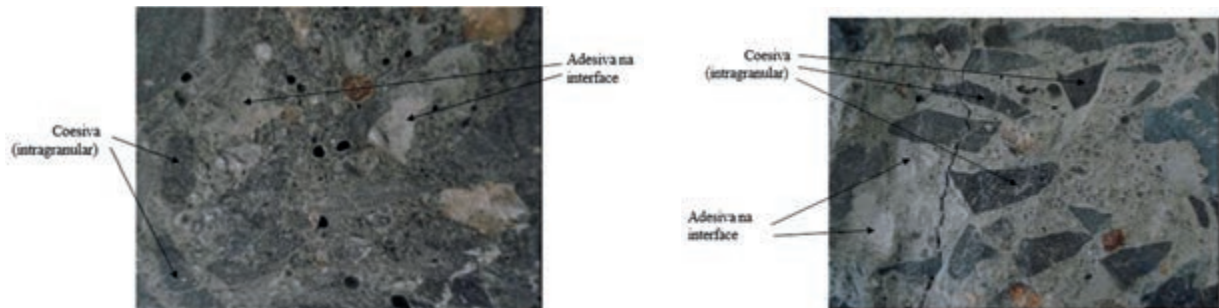
Figura 2: À esquerda, amostra não submetida ao tratamento térmico, e à direita amostra submetida ao tratamento térmico a 110°C.
