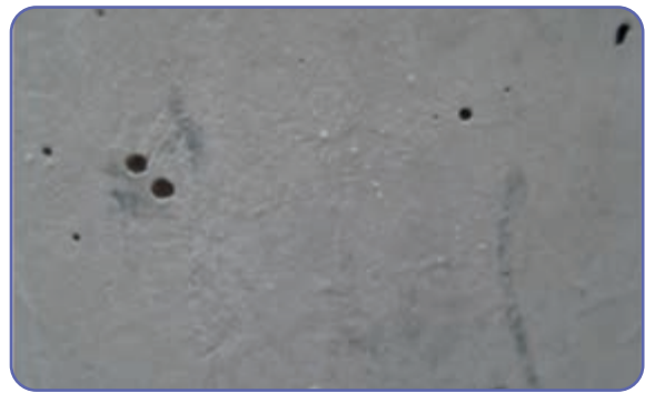
Foto 1: Imagem típica da superfície do concreto da amostra sem tratamento térmico.
