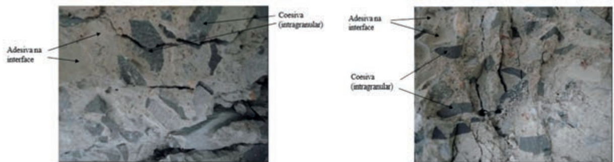
Figura 3: À esquerda, amostra submetida ao tratamento térmico a 300°C, e à direita amostra submetida ao tratamento térmico a 500°C.
