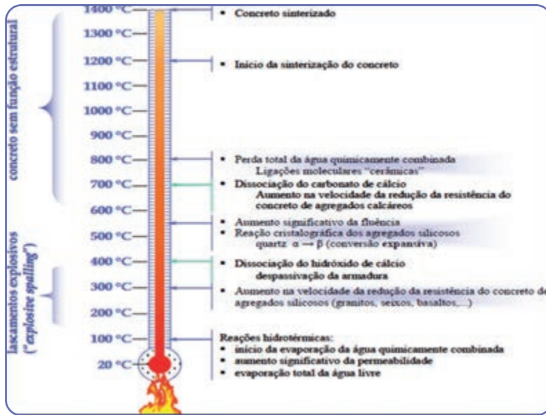
Figura 1: Transformações físico-químicas do concreto endurecido (COSTA, 2008).
