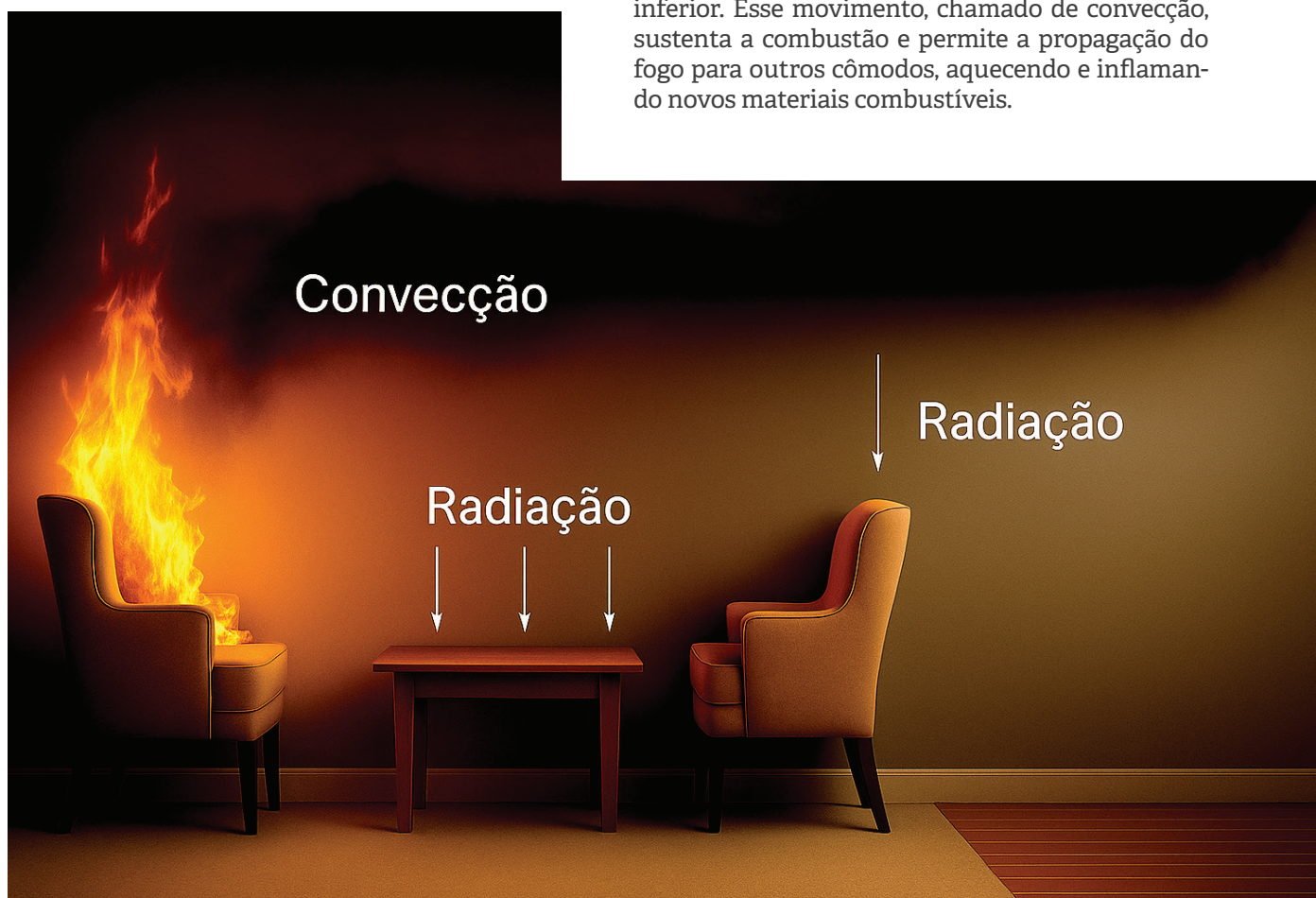
Figura 1: Fase crescente de um incêndio. Fonte: Image Generator do Chatgpt em 15/06/2025, adaptado NFPA 921.
